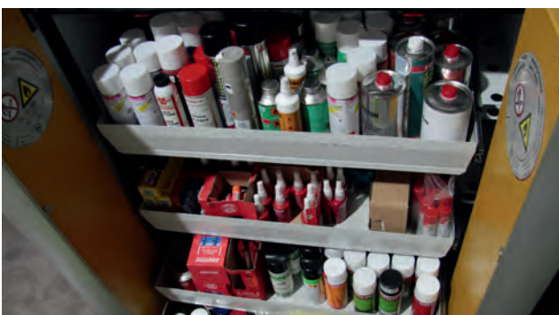
Die Abbildung zeigt einen handelsüblichen Sicherheitsschrank zur Lagerung von Gefahrstoffen.
